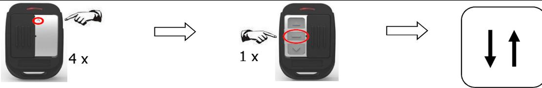
A) Presione 4 veces seguidas el botón MEMORY del transmisor. Escuchará un pitido. Presione el botón de 'stop' del transmisor, escuchará de nuevo otro pitido. La dirección del motor se ha cambiado.
