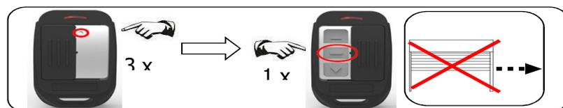
Con el motor parado, presione 3 veces el botón de MEMORY del transmisor. Seguidamente presione el botón de 'stop' y escuchará un pitido para confirmar que la tercera posición se ha borrado.
